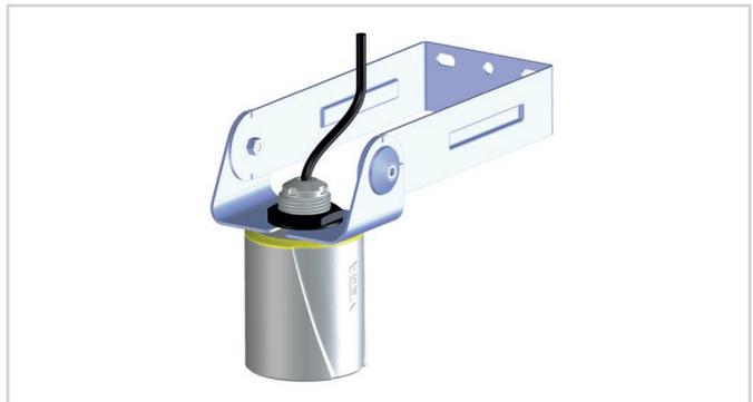
Esempio di staffa di montaggio – Montaggio a parete con alloggiamento del sensore regolabile
