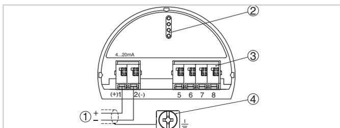
Vano dell'elettronica e di connessione della custodia ad una camera
