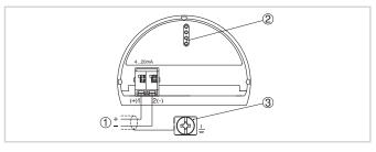
Vano dell'elettronica e di connessione della custodia ad una camera
