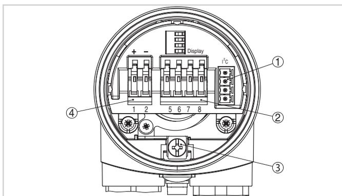
Vano dell'elettronica e di connessione della custodia ad una camera
